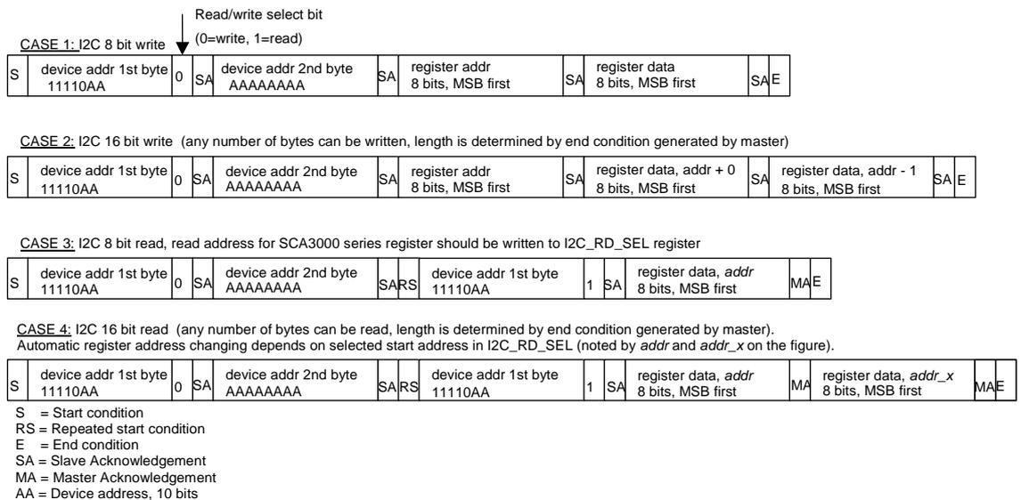
Figure 10. I<sup>2</sup>C frame format.
