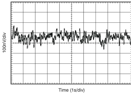
Figure 6-9. 0.1-Hz to 10-Hz Noise
